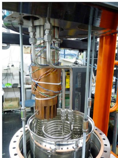
図 4.23 製作した液化機の写真 (容器は開いた状態)
