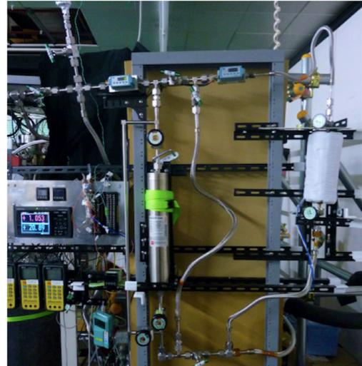
図 4.11 製作した循環ラインパネル
